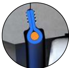
Disque en Position Ouverte. Siège non compressé.
