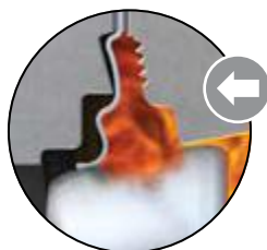
Pression de la ligne appliquée à partir du sens d'écoulement préfér é. (Pendant ou après l'incendie)
